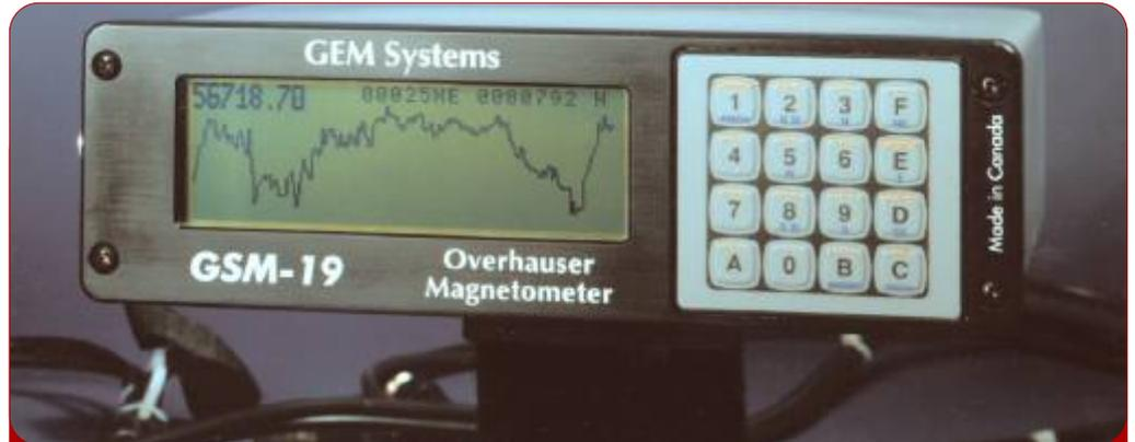
Consola del Magnetómetro portátil Overhauser (GSM-19W). También se puede configurar con un sensor adicional para las lecturas en el gradiómetro (simultáneos)
